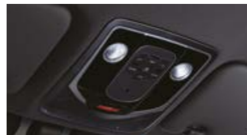
Konsola w podsuftce z oświetleniem punktowym
